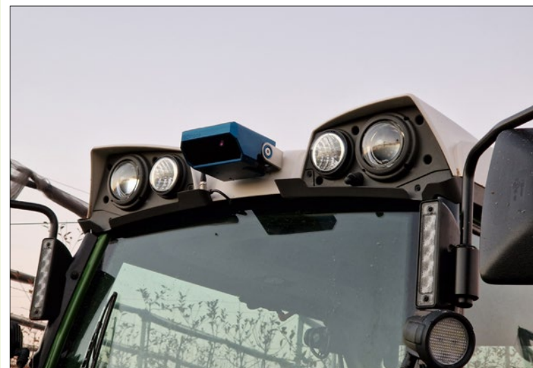
Met de nieuwe camera rijdt de tractor door bij over de grasbaan groeiende takken.
