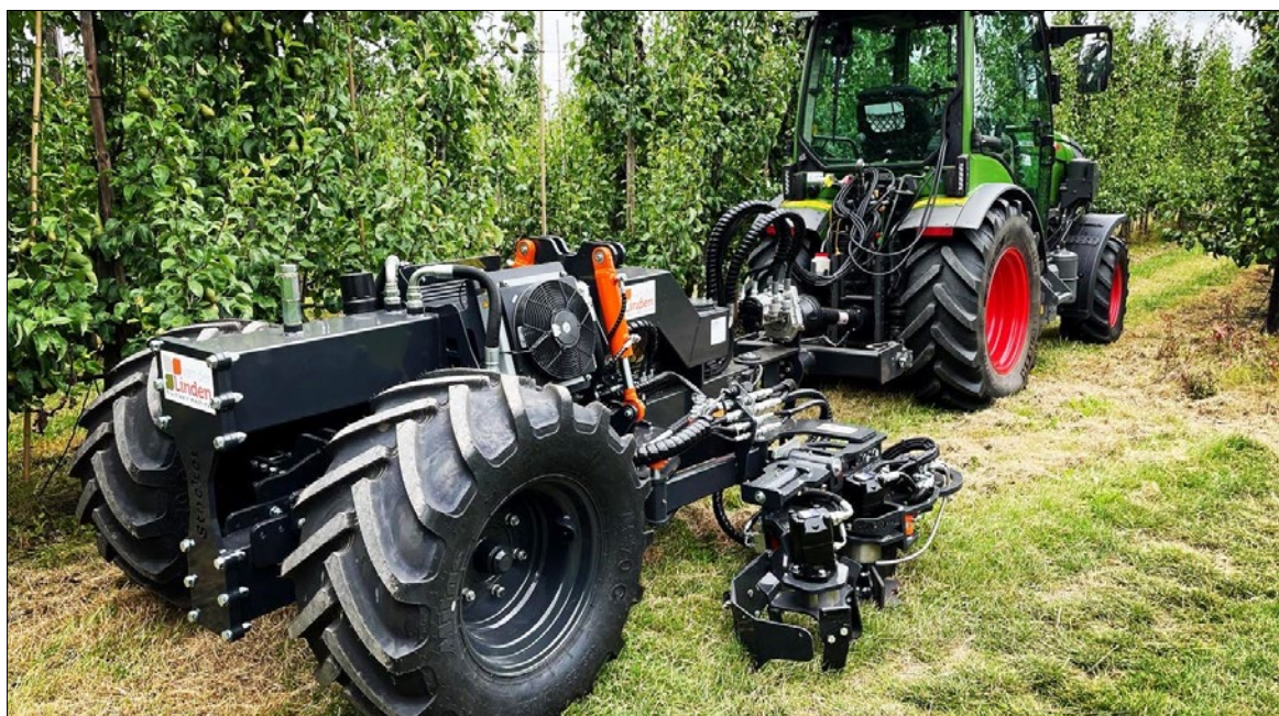
Met het iQuus-systeem kan de nieuwe machine voor mechanische onkruidbestrijding van Stocker Maschinenbau autonoom werken.
