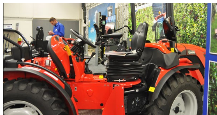
Het bestuurdersplatform kan met één handeling worden omgedraaid. Arjan de Bruine
