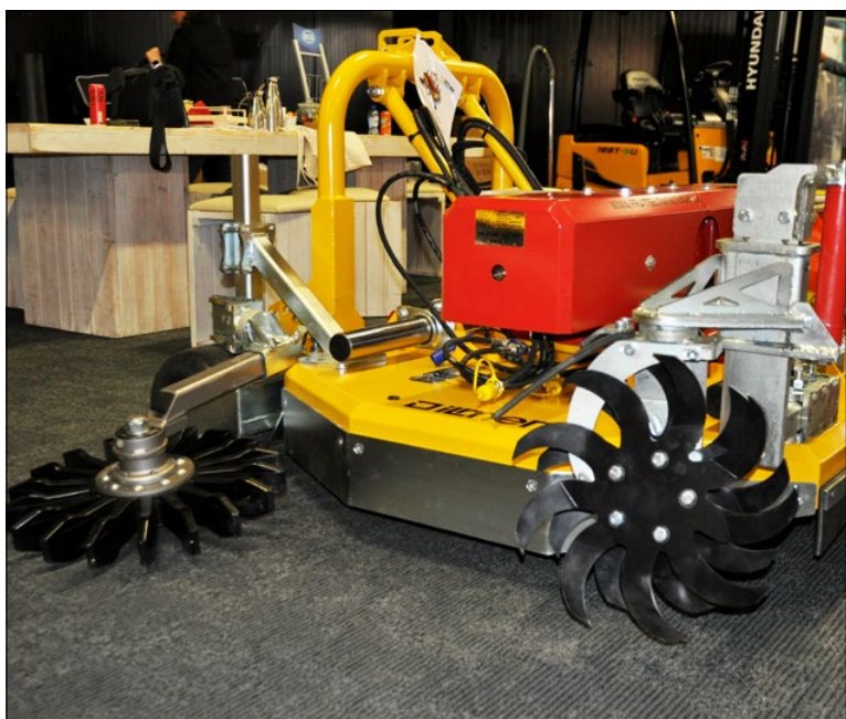
Op de LMG-maaiers van Ilmer passen aanbouwwerktuigen om tegelijkertijd onkruid te bestrijden. Arjan de Bruine
