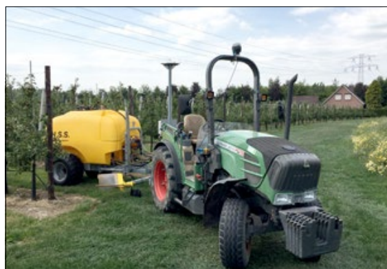
H.S.S. onkruidspuit met GPS
