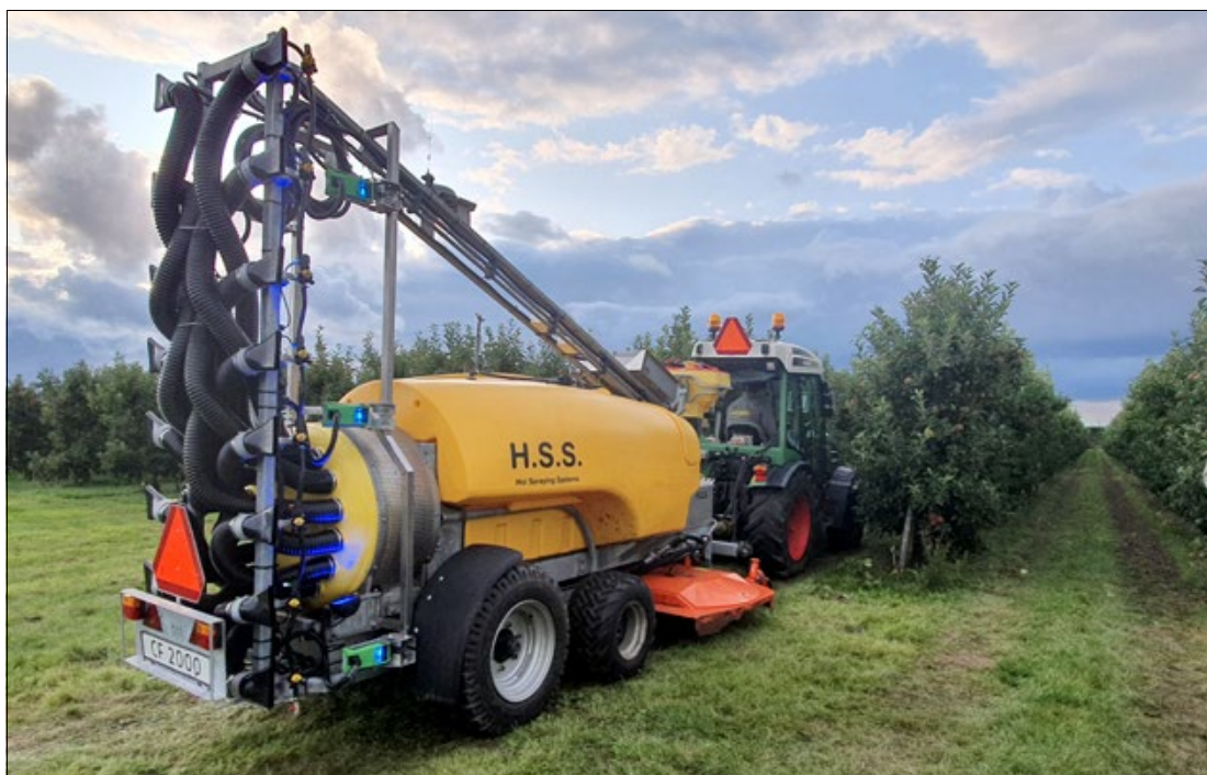
Met de H.S.S. Intelligent Spray Application® zijn plaats-specifieke besputtingen mogelijk.
