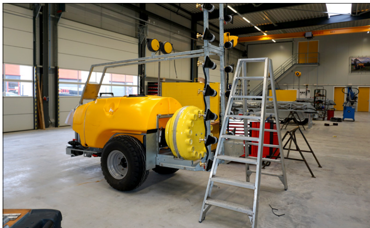
Montage eenrijige fruitteeltspuit in de nieuwe ruim opgezette hal. Bert van Sonsbeek
